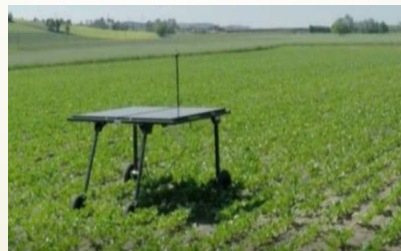
Caméras, logiciel d'analyse d'image, capteurs et GPS (source EcoRobotix)
